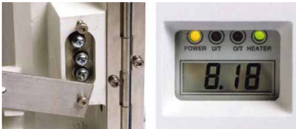
Рис. Регулировка выхода при калибровке Дисплей
